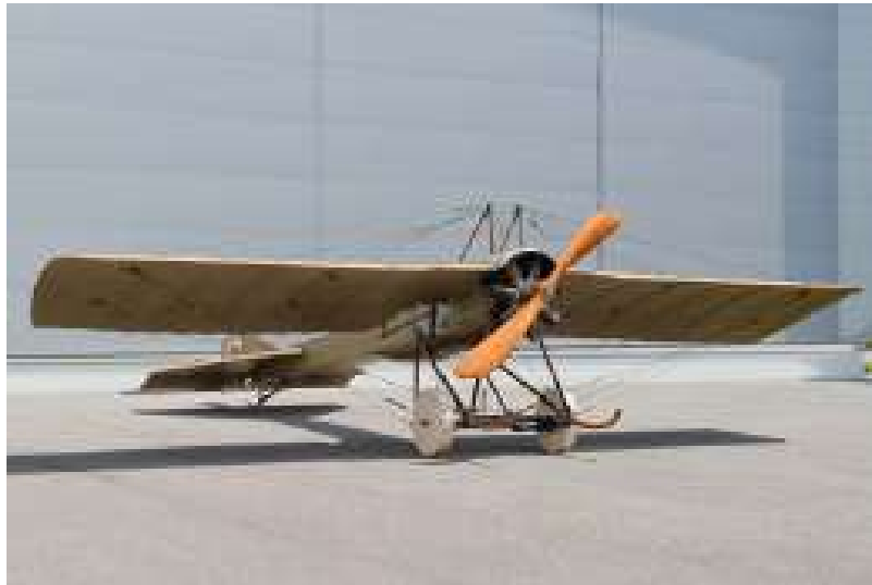
9. Béchereau, Deperdussin Aéroplane Deperdussin type B , 1911. Avion, Bois, toile enduite, peinture, métal, matériaux synthétiques, 240 x 750 x 850 cm Masse en charge 370 kg, Poids à vide 220kg, Surface alaire 14m 2 . Musée de l'Air et de l'Espace, Le Bourget. © Musée de l'Air et de l'Espace-Le Bourget / Photo Cyril Semenoff-Tian-Chansky
